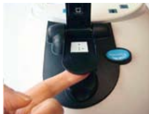
サンプル下部プレートの外し方 手で持ち上げるだけで 簡単に取り外せます。
