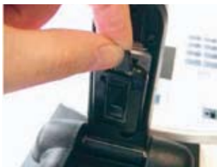
サンプル上部プレートの外し方 手でつまむだけで簡単に 取り外せます。
